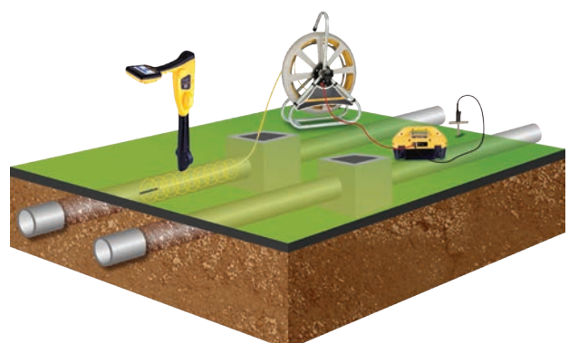
Streckenortung mit Schiebeaal, Signalsender und Leitungsortungsempfänger
