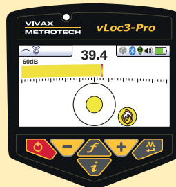
Markerortungs-Ansicht mit Tiefenanzeige auf Knopfdruck
