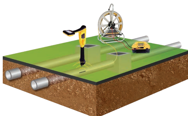
Punktortung mit Sonde am Schiebeaal, Signalsender und Leitungsortungsempfänger
